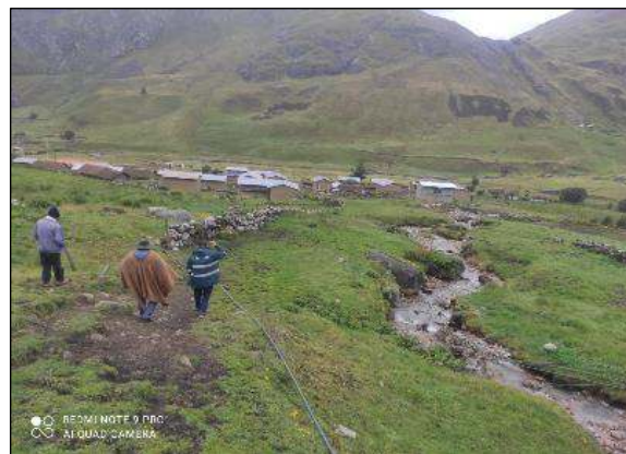
Figura 02. Se muestra un tramo de la quebrada que atraviesa una zona poblada, sin presencia de defensas ribereñas. Las viviendas cercanas, en su mayoría construidas con materiales rústicos, se encuentran expuestas a posibles desbordes, lo que representa un riesgo alto ante eventos de lluvia intensa.
